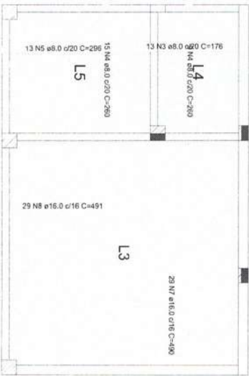
1 ARMAÇÃO POSITIVA DAS LAJES DO PAVIMENTO TÉRREO ESCALA 1:50
